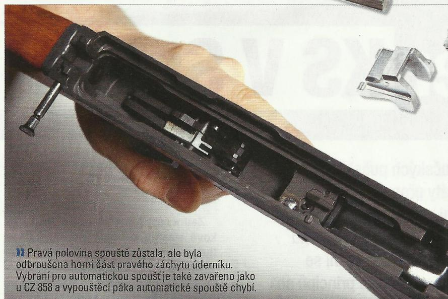
» Pravá polovina spouště zůstala, ale byla odbrúšena horní část pravého záchrnu úderníku. Vybrání pro automatickou spoušť je také zavařeno jako u CZ 858 a vypouštěcí páka automatické spouště chybí.
