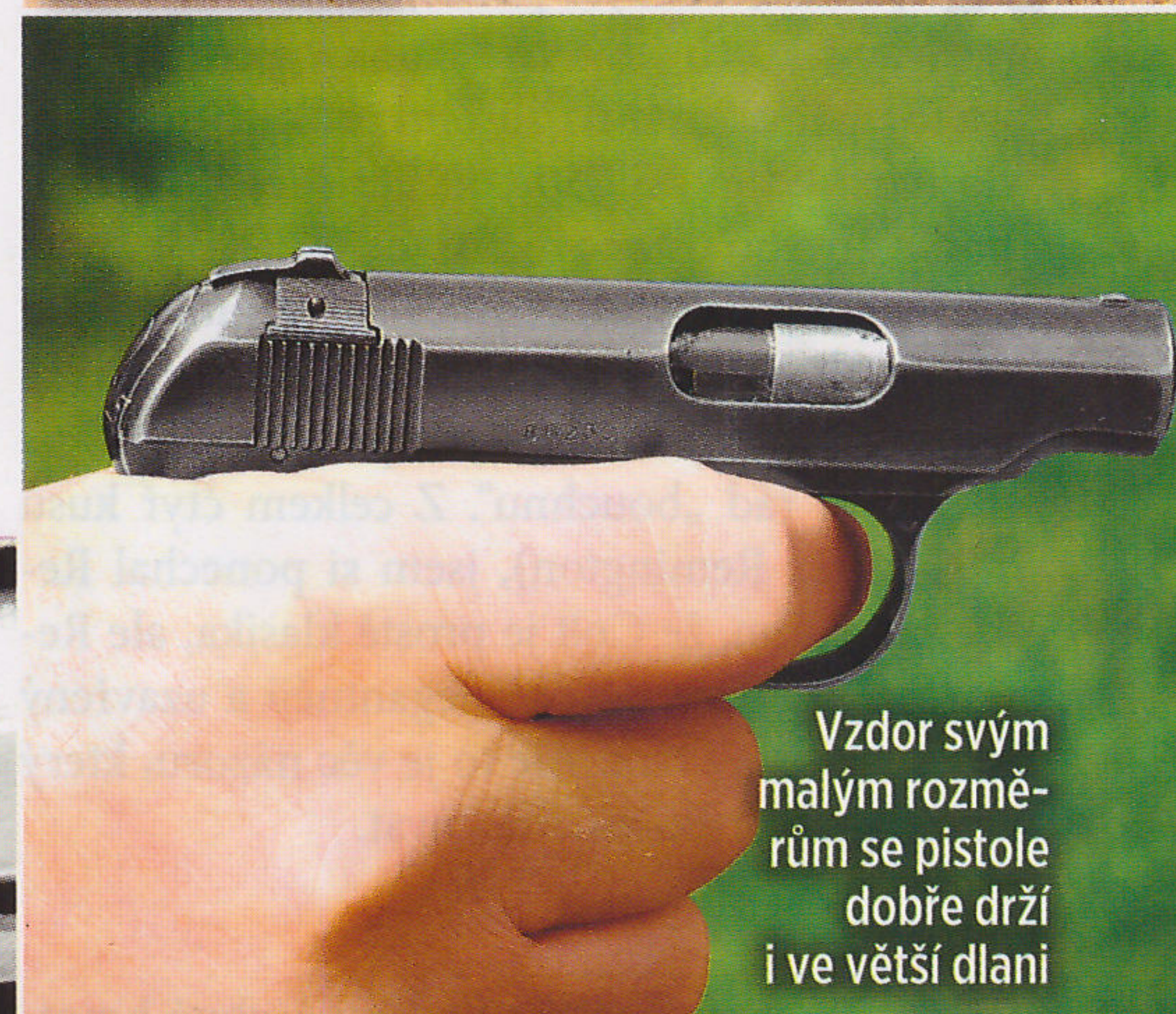
Druhý typ Melioru se liší od prvního typu pažbičkou a mírnějším obloukem v přechodu jejího spojení vzadu s tělem zbraně. Mechanická pojistka je umístěna těsně pod závěrem nad lučikem.
