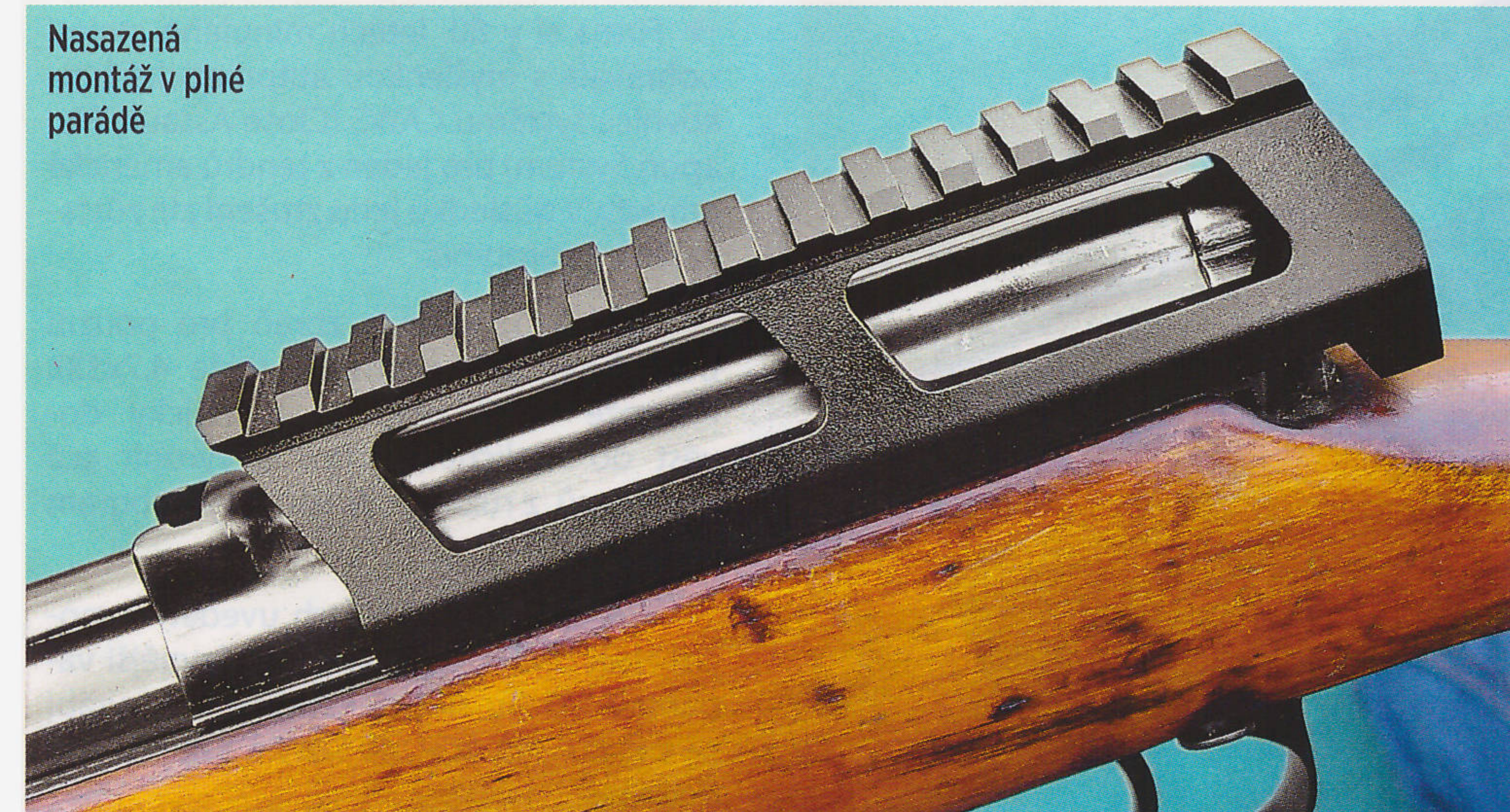
Takto vypadá montáž II. generace Aleše Chudoby na pušku Tokarev SVT-40, která umožňuje prakticky instalaci jakéhokoliv zvoleného puškohledu
