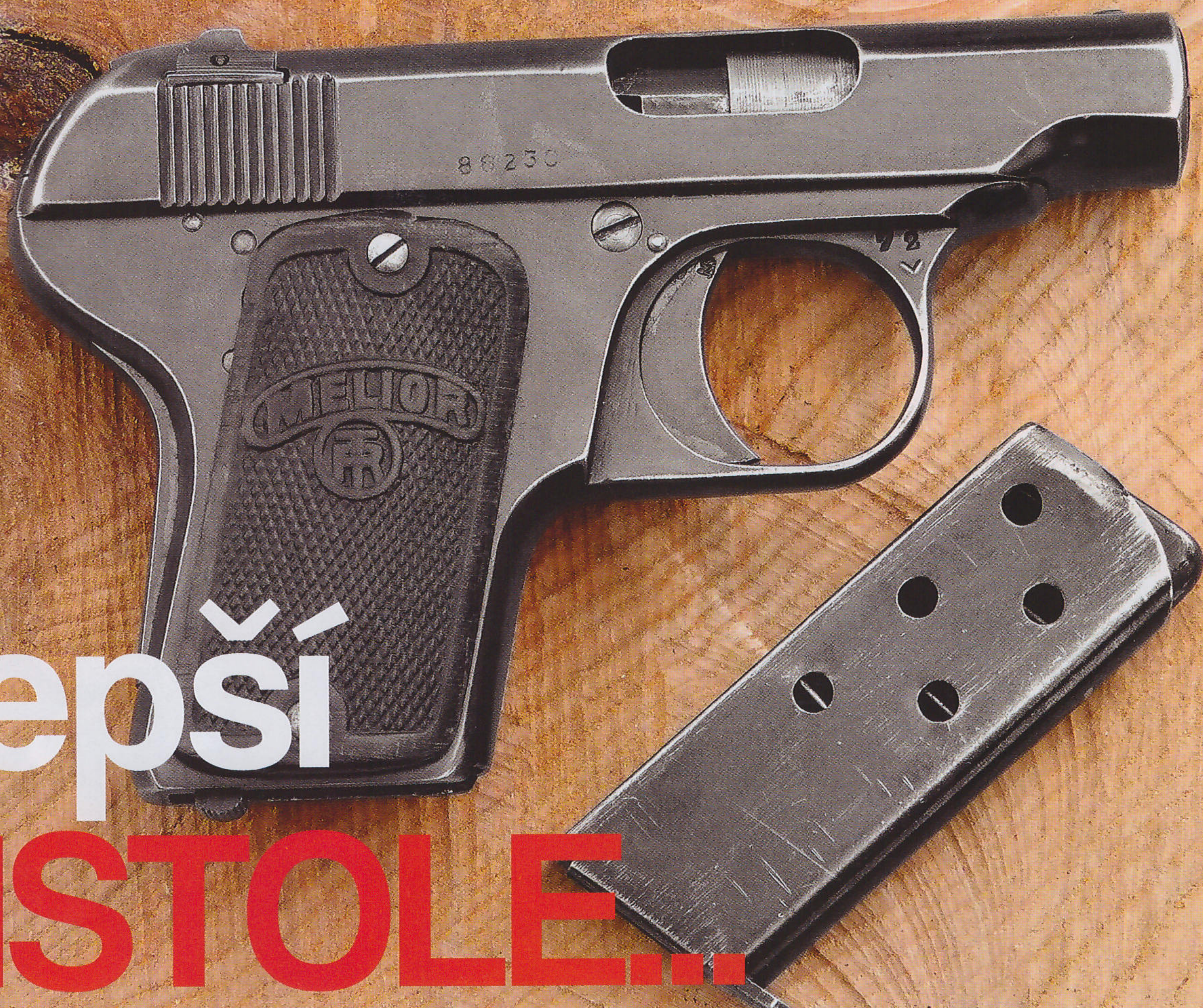
Pistole Melior New Model ráže 6,35 mm belgické výroby, zřejmě druhý typ (Type II). Zásobník je šestiranný.
