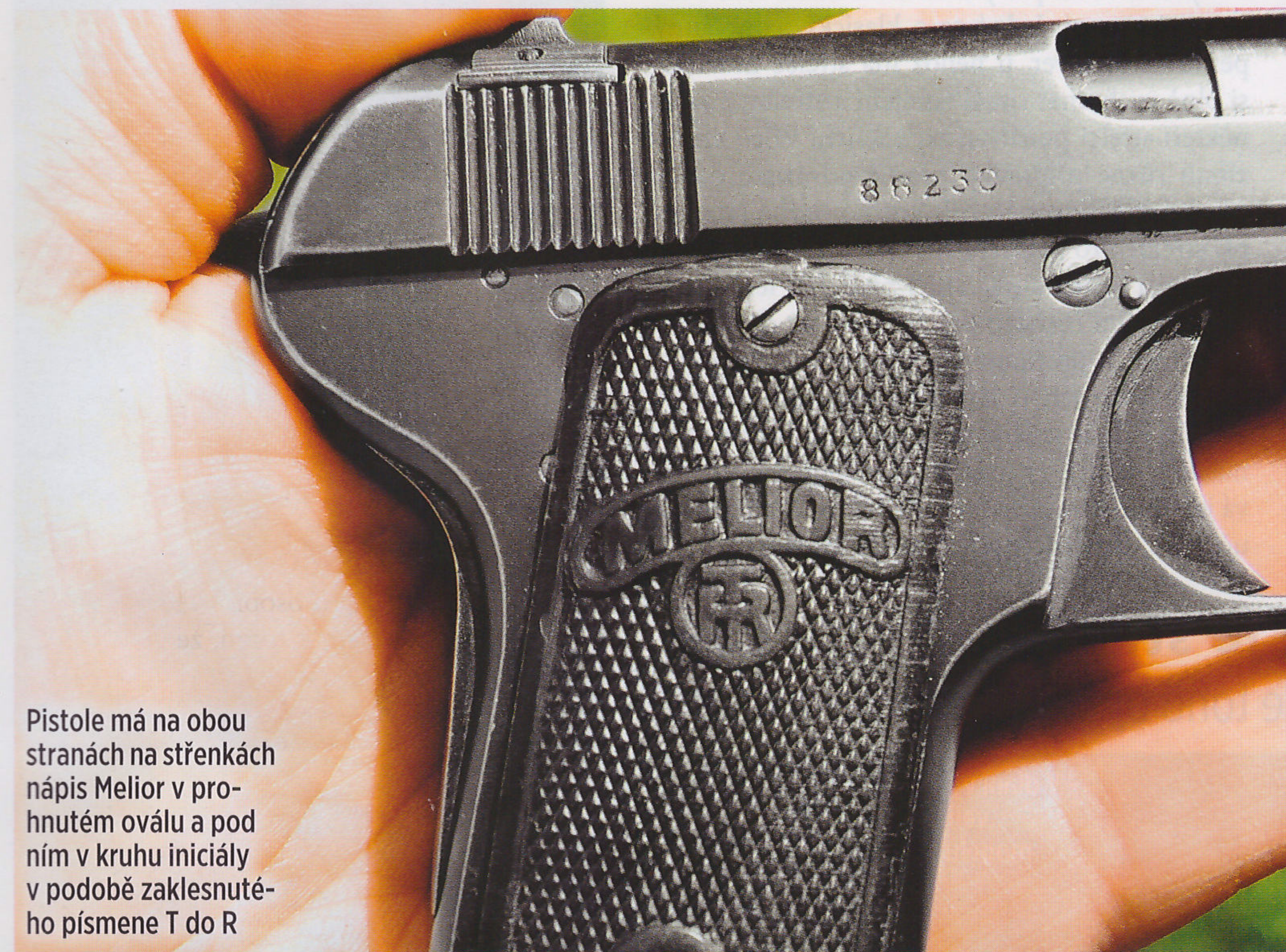
Melior v ráží 6,35 mm je prcek menší téměř než dlaň. Podle vyraženého nápisu na závěru používá licencovaný patent Brevets a jde podle některých charakteristických vnějších znaků o takzvaný druhý typ nového modelu
