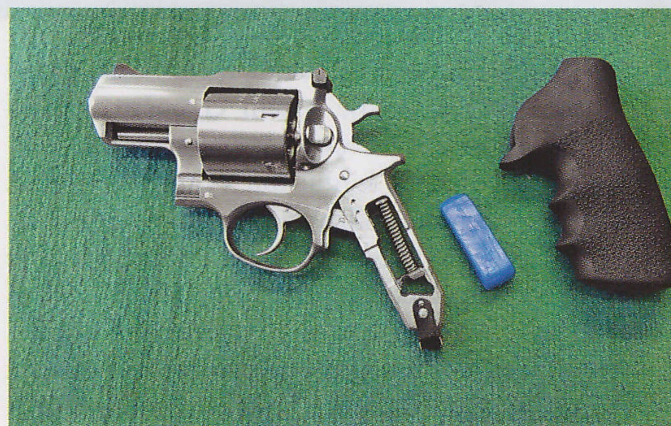
Pro lepší absorpci energie zpětného rázu je dovnitř rukojeti vkládán výrobcem ještě i speciální silikonový bloček
