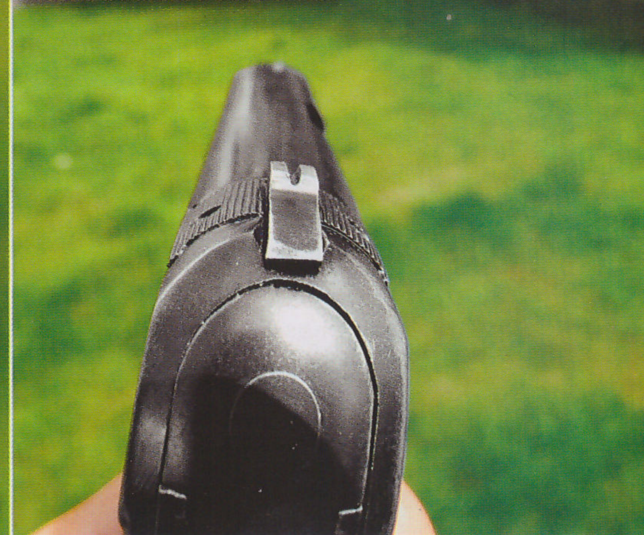
Ústí hlavně s pojistkou vratné pružiny
